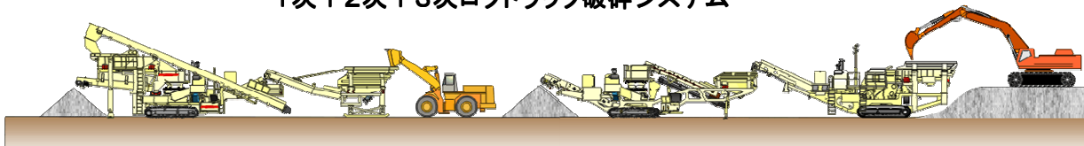
1次+2次ロコトラック破碎システム、原石ピン+3次ロコトラック破碎システム
